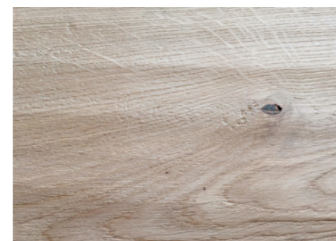
PIALLATO A MACCHINA CON FINITURA A MANO
